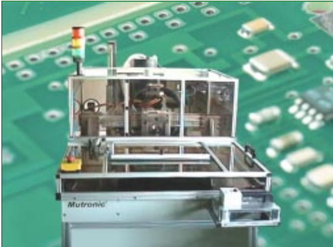
Für die Fertigung von mittleren und großen Serien im Ein- oder Mehrschichtbetrieb liefern wir CNC-gesteuerte Trennautomaten mit manueller oder automatischer Be- und Entstückung.
